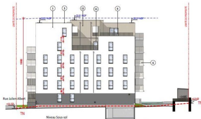
Élévation Nord Bâtiment A
